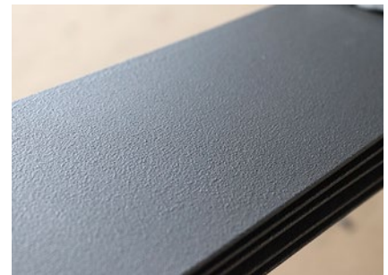
Corrosiebescherming met SikaCor ® EG-1 in het werk
