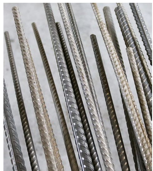
Geribdt staal vergelijkbaar met een materiaal 1.4003 volgens DIN EN 10088 (corrosieweerstandstandklasse 1)
